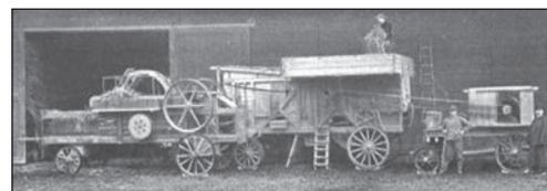
Um 1915 - So findet man schon bald eine solche moderne Antriebsanlage mit einem Elektromotor für die Dresch- und Bindemaschine
